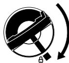
Tankverschluss mit Klappflügel (Bajonettverschluss) korrekt einsetzen, bis zum Anschlag drehen und den Bügel zuklappen.
