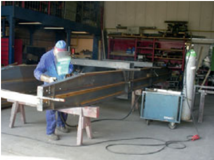
Abb. 10 Hohe mechanische und thermische Einwirkungen auf die Anschlussleitung des Elektroschweißgerätes
