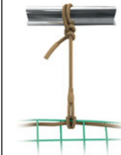
a) Einsträngiges Aufhängeseil L (Seilbruchkraft \geq 30 kN)
