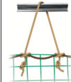
b) Zweisträngiges Aufhängeseil Z (Seilbruchkraft \geq 15 kN)
